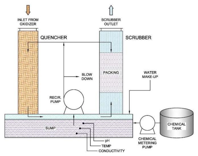
TYPICAL HQS QUENCHER SCRUBBER SCHEMATIC
