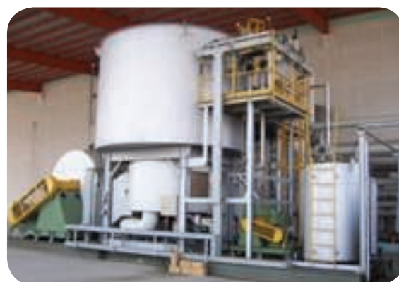
装置名称：转塔式 RTO 应用行业：覆铜板行业 CCL Manufacturing RL type RTO
